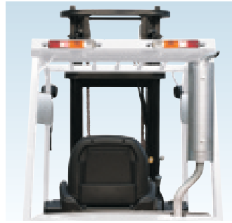
Система выпуска -- установлена на защитной крыше
